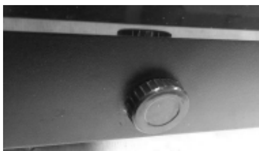
Orificio con tapón para la salida del agua. Se encuentra en la parte inferior izquierda en el exterior del equipo.
